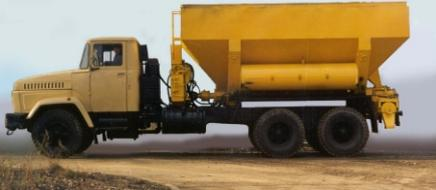
Зарядание скважин производится как игданитом, приготовляемым в процессе зарядания, так и взрывчатыми веществами заводского производства, допущенными Госгортехнадзором России для механизированного зарядания. Условия эксплуатации: районы с умеренным климатом, исполнение У, категория размещения 1 по ГОСТ 15150-69.
